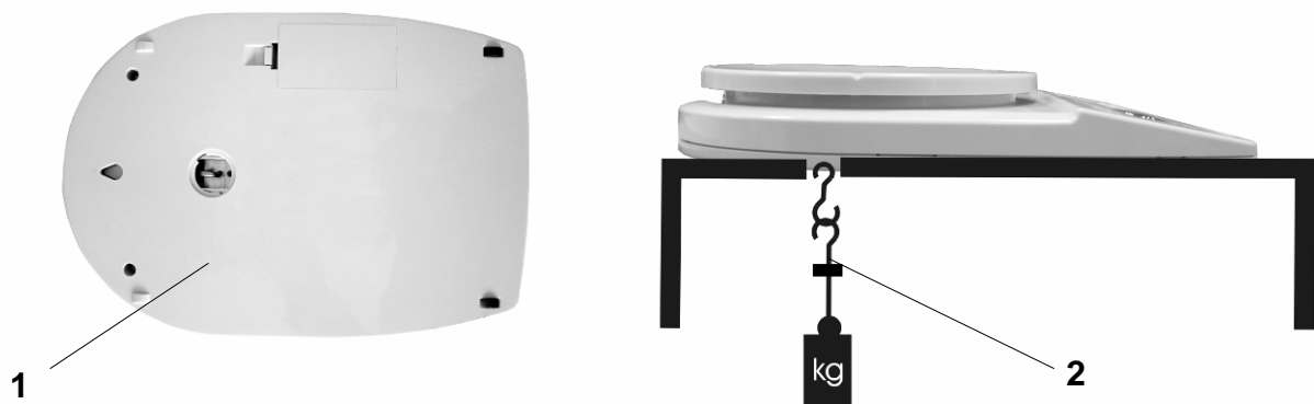
Afb. 1: Weegschaalinstelling voor wegen onder de vloer
